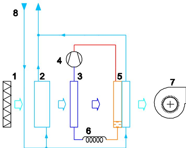
Fig. 1 Schema del deumidificatore DMI
