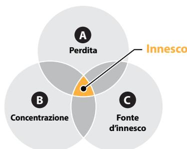
Il rischio di infiammabilità delle unità MEHITS con refrigerante R32 è minimo. Tuttavia, le normative locali potrebbero richiedere un'analisi dei rischi nel luogo di installazione.
